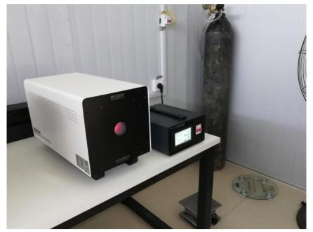
BR1450中高温黑体辐射源/黑体炉温度范围宽广,由100~1450℃内任意一温度点皆可随需要调整。稳定、重 复的校正面板让使用者能快速而准确地校正及测试红外线高温计(红外测温仪)。黑体开孔直径**Φ32mm**的面积, 适用大部份的红外线高温计(红外测温仪)。系统另有RS-232或485的计算机通讯接口方便计算机控制设定温度 及自动测试。功能特点: ●温度范围: 100~1450℃ ●采用自动升温控温方式、安全可靠、温度稳定性好、使用 操作方便●使用双排数字显示测量值及设定值●紧凑而坚固的设计、集校准与测试的完美结合\*\*\*,经一段时间 风扇冷却,使得黑体炉温度降至室温后,即可拔电源插头。上海高温黑体炉价格
