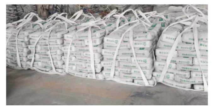
早期强度高、后期强度不倒缩东曜路桥水泥路面快速修补料具有较高的小时强度,多次实验表明,其4 小时强度稳定在35mpa以上,满足快速开放交通的要求。同时因为材料中复配有特殊的胶凝材料,使其后期强度持续增长,避免了一般快硬材料强度倒缩的通病。不收缩、微膨胀东曜路桥水泥路面快速修补料具有补偿收缩的功能,不需要使用界面剂处理,与老混凝土基一有良好的粘结能力,同时能够避兔或控制内部及面层裂缝的出现。优异的耐久性经高分子聚合物改性后,东曜路桥水泥路面快速修补料集中了无机材料和有机材料的优点,混凝土路面修补料价格,混凝土地面翻砂如何处理,材料具有适宜的力学强度和较好的柔韧性,对公路车辆的频繁荷载有良好的适应能力,同时抗渗性能优异增强了其耐久性。东曜新材料售卖道路快速修补灌浆料,品质有保障。舟山孔道压浆料哪家好
